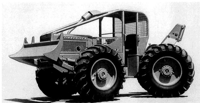
Timberjack – en rammestyrte skogstraktor med vinsj for fremkjøring av hele stammer. Dette er en 1973-modell. Traktoren som Løvenskiold kjøpte i 1964 var svært lik denne. Dette var kanskje den første skogstraktoren av dette slaget i distriktet. Bilde er utlånt fra Leif Kjølseten
