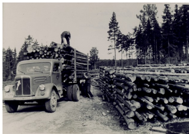
Morten Johansens Scanie Vabis innkjøpt i 1956. Bakre hjulgang, som ses på bildet, ble heist opp på bilen under tomkjøring. De fikk 20-25 m3 med seg på lasset. På bildet står Rolf Eriksen oppe på lasset og Werner Johansen ved siden av. De hadde tømmer-transport både fra Løvenskioldskogen og fra Varald-skogen. Bildet er fra slutten av 50-åra.
